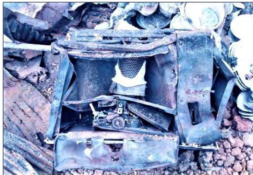
写真8 現場焼損したストーブを鑑識し、矢印に示すように耐震装置が働いていることを確認。
