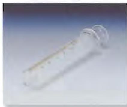
瞬間値の測定あるいは高温ガス、高濃度ガスを測定する場合に使用します。内容量100mlと200mlがあります。
