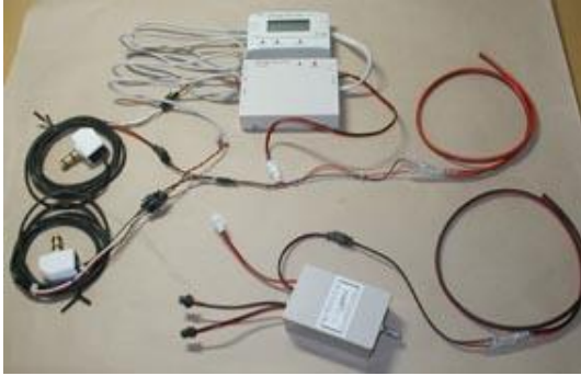
圧力センサ、データロガー、電源RC、DC-DCコンバータ
