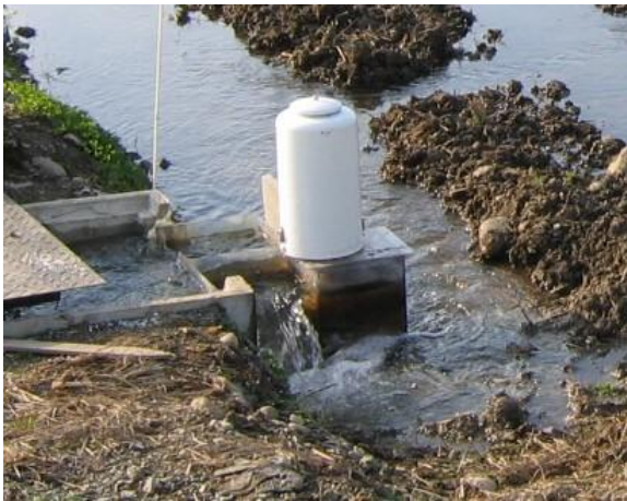
水田に設置した例です。 水位の測定にフロート式水位計を使用しています。
