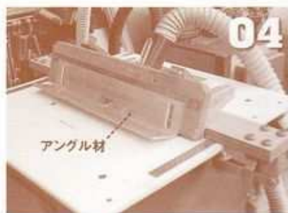
04 ここでフェンスにアンクル材を取りつけられるように工夫した。これで小さな材も確実に加工できる
