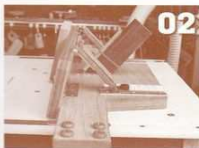
02 作りたい器の角度に合わせてフェンスの傾斜を設定し固定する
