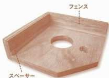
テンプレート設置用ジグのフェンス下部には、2mmオフセットするためのスペーサーが張りつけてある
