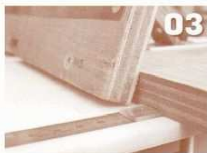
03 フェンスを傾斜させるとフェンスの下端にすき間ができる。小さな材の加工には都合が悪い
