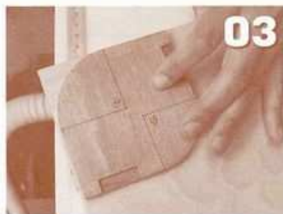
全体がずれないようにひっくり返して、設置用ジグを取りはずす。すると加工される材の上に2mmオフセットされた切削用テンプレートが残る
