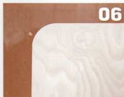
切削後、切削用テンプレートを取りはずせば、トリマーならではの滑らかな角丸ができあがる
