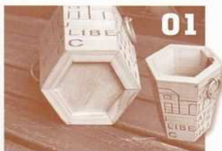
01 下すばまりのころび傾斜がついた器。底面と水平に底板を差し込む溝を彫りたいときに使う
