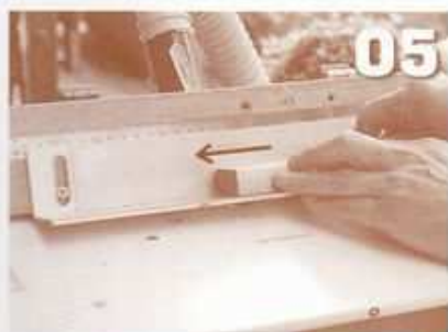
05 アンクル材の上を滑らすように材を動かして溝を彫る
