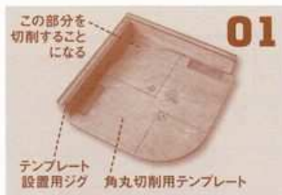
テンプレート設置用ジグに、必要なサイズの角丸切削用テンプレートをスペーサーに密着するようにセットする。フェンスの入隅に向けたテンプレートで加工する
