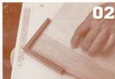
加工する材をセットしたジグの上にかぶせ、設置用ジグに密着させる。加工する材の下にある切削用テンプレートはこの時点ですでに2mmオフセットされている
