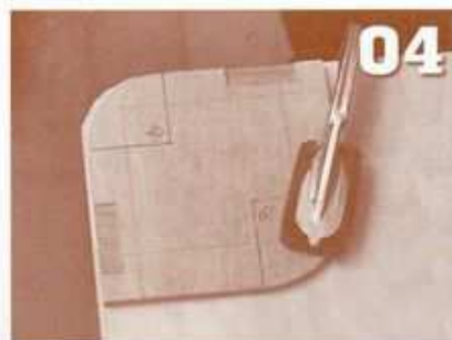
材の角部分はあらかじめノコギリで大きめに切り取っておく。これでトリマーに掛かる抵抗が減り、スムーズに動かすことができる
