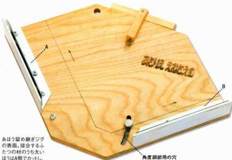
あほう留め継ぎジグの表面。接合するふたつの材のうち太いほうはA側でカットし、細いほうはB側でカットする。ジグに描かれた矢印はノコギリの刃を動かす向き。角度調節用の穴は5mm径ストレートビットをつけたトリマーで彫った
