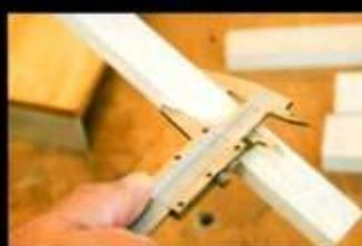
材の幅を正確に測るにはノギスが必須
