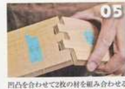
05 凹凸に合わせて2枚の材を組み合わせる
