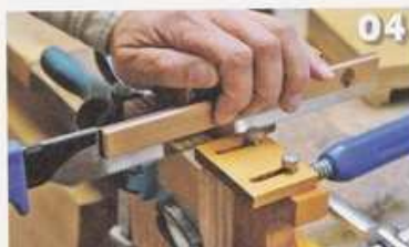
04 先の溝切りと同様に材を2枚まとめてクラップで固定し、残った2本の溝を切り込む
