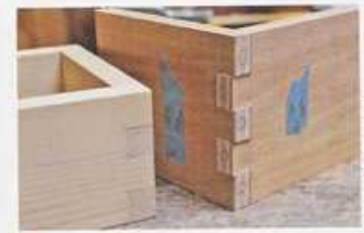
05 凹凸に合わせて2枚の材を組み合わせる
