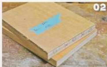
02 組み上がったとき外側になる面に印をつけておく。写真では青いテープを貼っている
