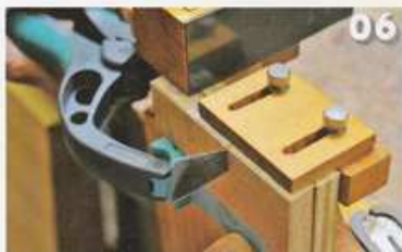
06 墨線をずらして2本目の墨線にジグを合わせる
