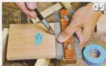
05 外側は組み接ぎが完成したときケガキ線が残るのを防ぐため、裏側と同じ位置に鉛筆で墨線を引く
