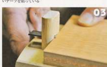
03 ケビキを材の木口に当てて、材の厚みより気持ち広く、ケガキ幅を決める
