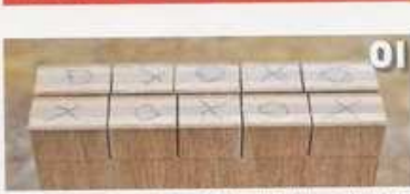
01 2枚の材を反対側にずらして残り2本の溝を切り、合計4本の溝を切る作業を行なう
