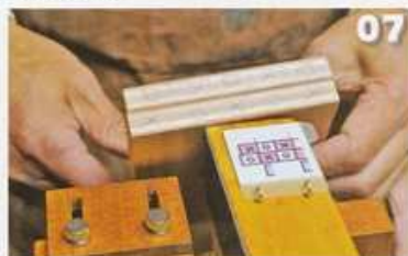
07 ジグ側(写真手前)の板が刃の厚さ分だけ左にずれている状態を動かないように保持して、ジグに取り付ける
