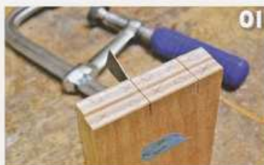
01 まず写真の2カ所に切り込みを入れる作業をする
