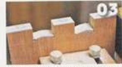
03 3枚の凸部のある板の糸ノコを使った切り抜きが終わったところ
