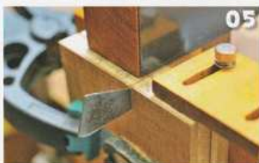
05 今切った溝に使用するノコギリと同じ厚さの金属片を差し込み、2枚の材がずれないようにする
