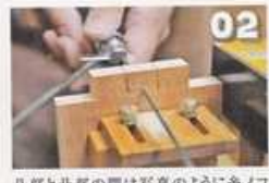
02 凸部と凸部の間は写真のように糸ノコを使って、切り抜く
