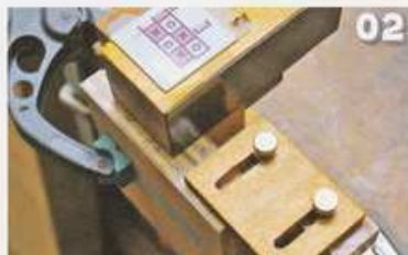
02 2枚をまとめてクランプを使い、ジグに固定した状態で作業者側から見る
