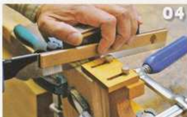
04 ストッパーを付けたノコギリをゴム磁石に沿わせて切り込む。ストッパーが材に達すると、滑って所定の深さより切れない
