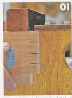
01 切り込みの入った材は写真のように、ジグに横付けして、×印部分を切り取る
