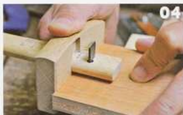
04 木口厚さプラス1mm程度の幅に寸法を写したケビキで材の裏側に墨を引く
