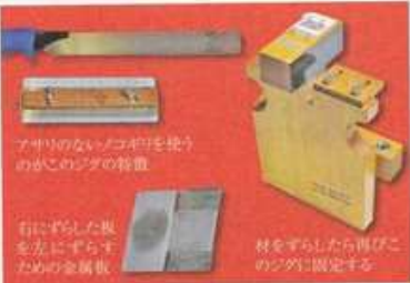
03 このようにジグ備（写真手前）の板が、ノコ刃の厚さ分右にずれた状態で固定する
