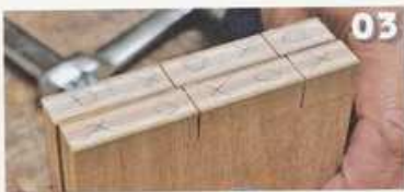
03 このようにジグ備（写真手前）の板が、ノコ刃の厚さ分右にずれた状態で固定する
