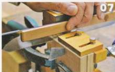
07 1本目の切り込みと同じように2本目の溝を切る。写真01のよう に2枚の材に2本の溝が切れる
