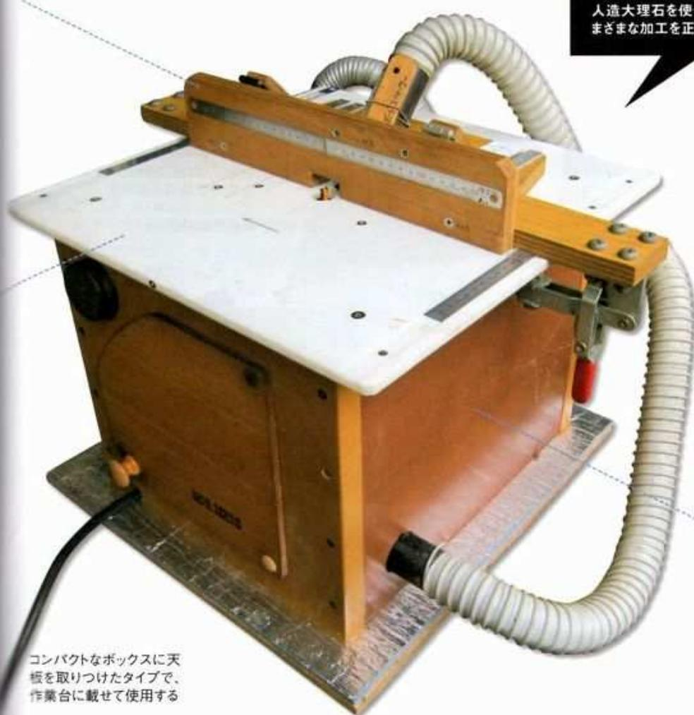
コンパクトなボックスに天板を取りつけたタイプで、作業台に載せて使用する
