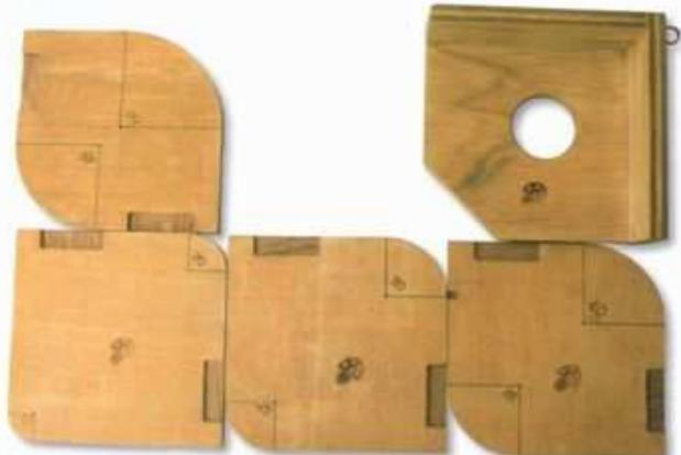
4枚のテンプレート板とテンプレート配置用ジグ(右上)。1枚の板に、Rサイズ(円の半径)が異なるふたつのテンプレートがあり、計8サイズの角丸切削用テンプレートとなっている。なお、このテンプレートはP70の円形切り出しじグを使って製作
