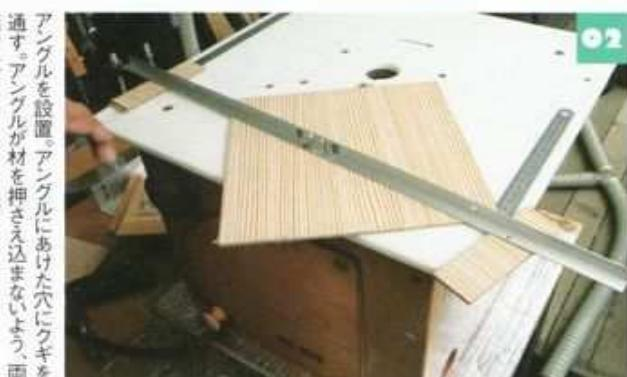
△サイズ(円の半径)を決め、材に立てたクギとビットの間隔を、その寸法に合わせる
