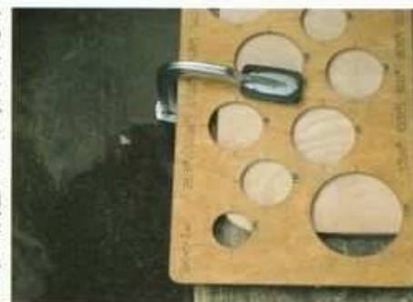
ビットの突き出し長さを3mm程度に設定
