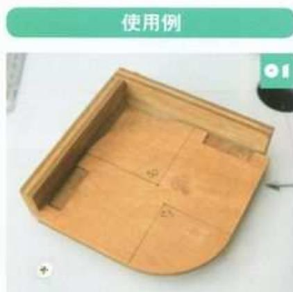
配置用ジグにテンプレートをセットする。テンプレートをスペーサーに密着させると、フェンスとテンプレートとの間に2mmのすき間ができる
