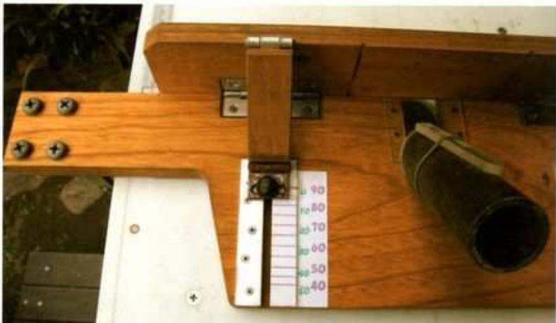
フェンス背面に、蝶番を介してステーを設置。ステー下端を留めるネジをゆるめてスライドすれば、ステーとともにフェンスの角度が変わる。フェンス本体も蝶番留めのため傾く
