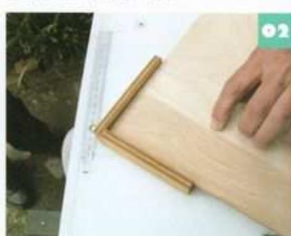
テンプレートの上に材をセットする。材はフェンスに密着させる
