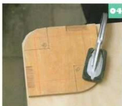
テンプレートと材をクランプで固定し、材の角部分をノコギリで粗切りする。ただし、材がテンプレートより2mm以上大きい状態にしておく
