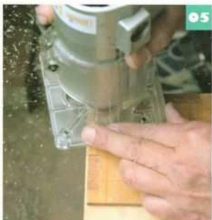
テンプレートガイドをテンプレートに沿わせながら6mm径ストレートビットで切削する
