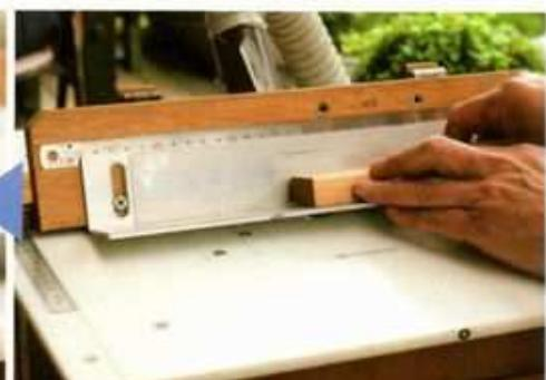
傾斜させたフェンスにアングルを留め、その上に材を送って切削する。もちろんアングルはビットが通るように切り欠いてある
